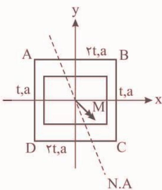
بردار لنگر روی مقطع همواره عمود بر امتداد بارگذاری بوده و در نتیجه بردار لنگر  $M$  عمود بر راستای قطر  $BD$  یعنی در راستای قطر  $AC$  می‌باشد. از طرفی محورهای اصلی مقطع محورهای  $(y, x)$  محورهای تقارن مقطع بوده و با کمی دقت می‌توان دریافت محور ضعیف مقطع ( $I_{min}$ ) محور عمودی  $(y)$  می‌باشد (چرا؟) بنابراین مقطع تحت خمش ۲ محوره قرار داشته و می‌دانیم در مقاطع تحت اثر خمش دو محوره محور خنشی همواره بین بردار لنگر روی مقطع و محور ضعیف مقطع قرار گرفته و لذا گزینه (۴) پاسخ صحیح خواهد بود.
