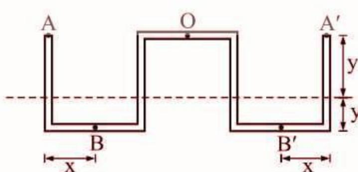
**تذکرہ:** در هیچکدام از نقاط جدارهای قائم میانی مقطع نیز ممان استاتیک و در نتیجه تنش برشی نمی‌تواند صفر شود. در نتیجه تنش برشی در جدارهای قائم فقط در نقاط A و A' برابر صفر است.
