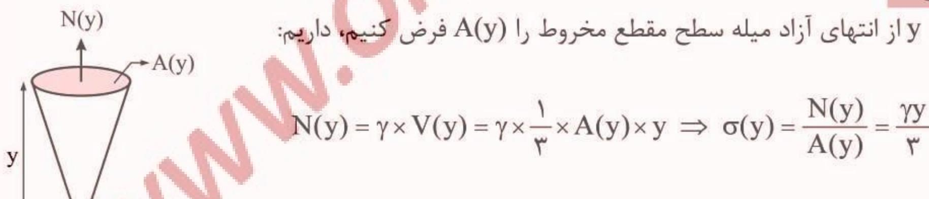
از طرفی مقادیر  $\sigma_z = \sigma_x$  و  $\sigma_y$  بوده و با انتخاب یک المان به ارتفاع dy در مخروط تغییر ارتفاع به صورت زیر محاسبه می‌شود:
