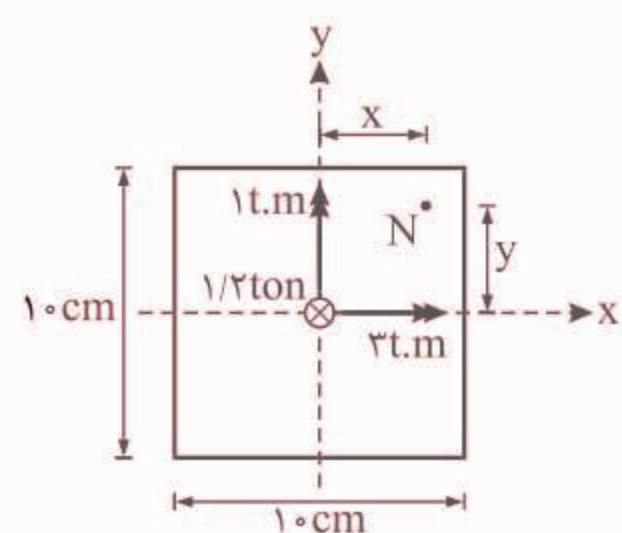
$$\begin{cases} \text{فشاری} \frac{-1/2 \text{ ton}}{(10 \times 10) \times 10^{-4}} = -120 \text{ ton/m}^2 \quad \text{تنش ناشی از نیروی } 1/2 \text{ تن} \\ \text{کششی} \frac{+M_x \times y}{I_x} = \frac{3 \times y}{(0.1)^4} = 3/6 \times 10^5 y \text{ ton/m}^2 \quad \text{تنش ناشی از لنگر ۳ تن - متر} \\ \text{فشاری} \frac{-M_y \times x}{I_y} = -\frac{1 \times x}{(0.1)^4} = -1/2 \times 10^5 x \text{ ton/m}^2 \quad \text{تنش ناشی از لنگر ۱ تن - متر} \end{cases}$$
