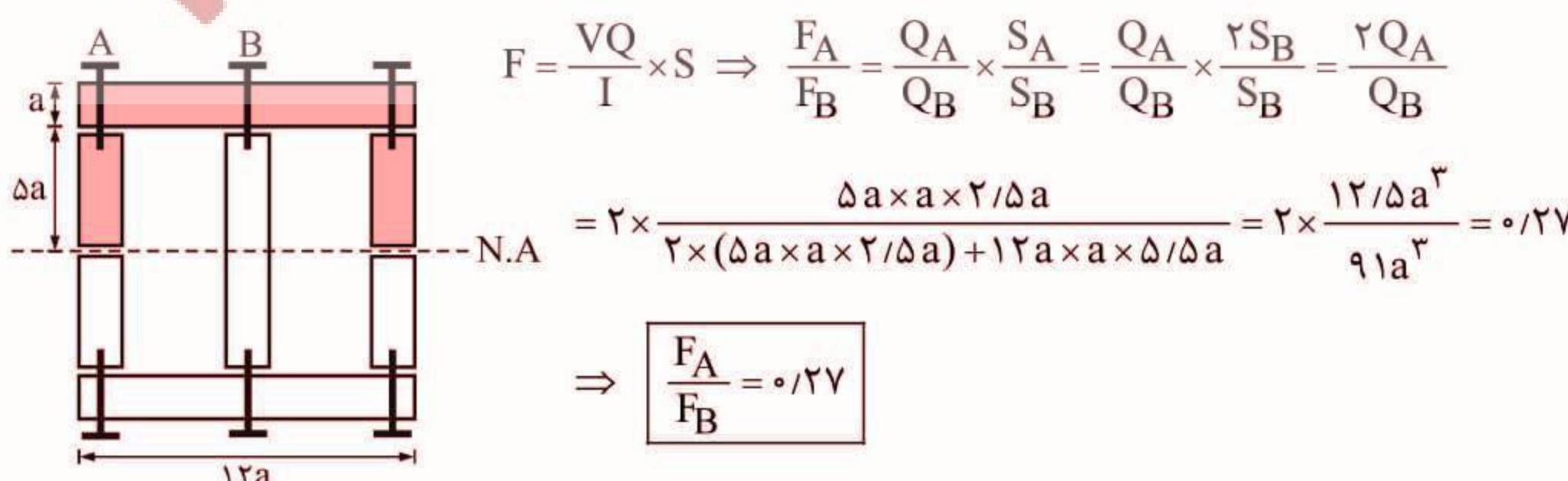
تنش برشی ناشی از لنگر پیچشی و تنش عمودی ناشی از لنگر خمی برابر است با:
