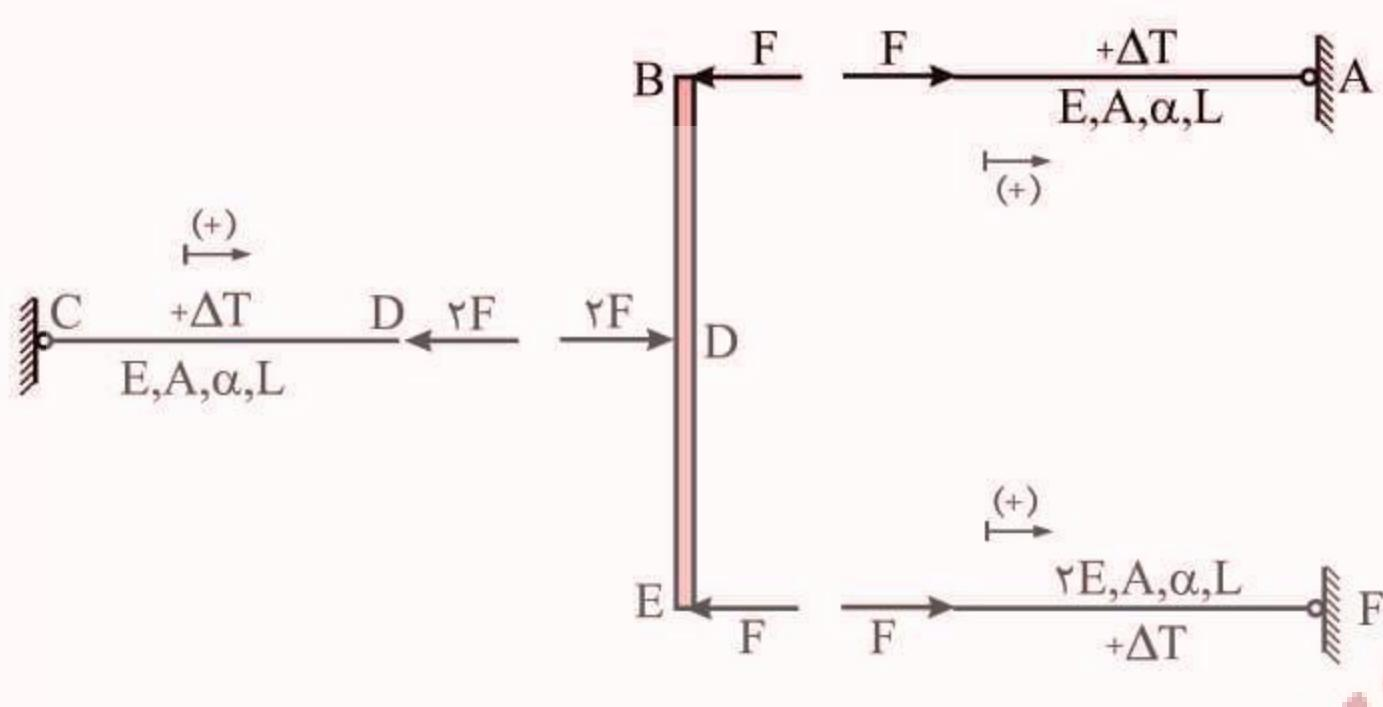
این سازه یک درجه نامعین است. برای حل اگر حرکت به سمت راست را مثبت فرض کنیم و با فرض اینکه نیروی میله AB برابر F و فشاری است (نیروی سایر میله‌ها به سادگی بر حسب معادلات تعادل به دست می‌آید)، به صورت زیر عمل می‌کنیم:
